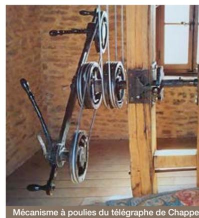
Mécanisme à poulies du télégraphe de Chappe
